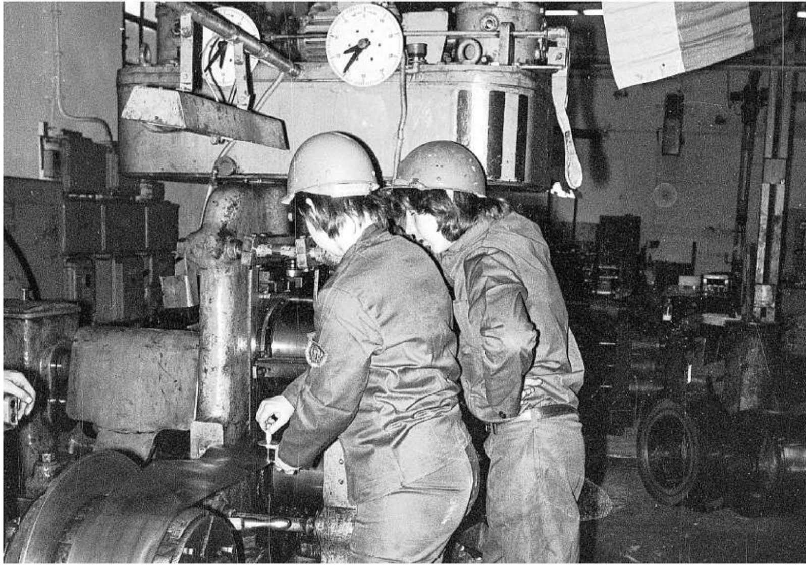
Arbeit am Sechserrollengerüst des Kaltwalzwerks Oranienburg
